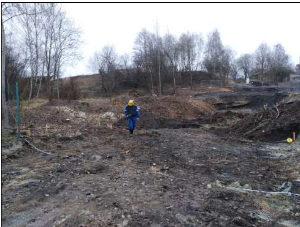
Obr.8 Pyrotechnik s magnetometrem zkoumá plochu 9. Kolík u plotového sloupku vyznačuje pozici 0/0 zkoumané plochy.
